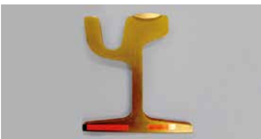
Rails (Alloy 317L) Soudotape 309L + Record EST 307
