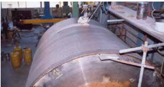
Paper Rolls (Alloy 14Cr2Ni1Mo) Soudotape 430 + Record EST 452
