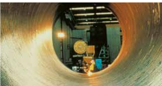
Separator Vessel (Nickel alloy 625) Soudotape 625 + Record EST 201
