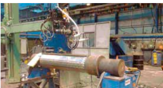
Forging – Punching Tools (Alloy C276) Soudotape NiCrMo59 + Record EST 259 Soudotape NiCrMo4 + Record EST 259
