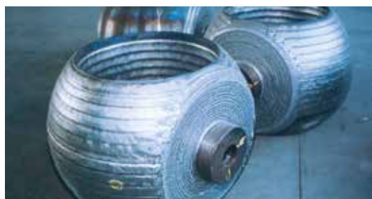
Ball Valves (Nickel alloy 625) Soudotape 625 + Record NFT/EST 201
